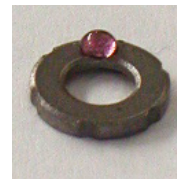
写真：焼結シールキャップに油を滴下 焼結シールキャップ：φ3×φ6×L0.9mm オイル：PSL-20 (17.8mm 2 /s/40℃)
